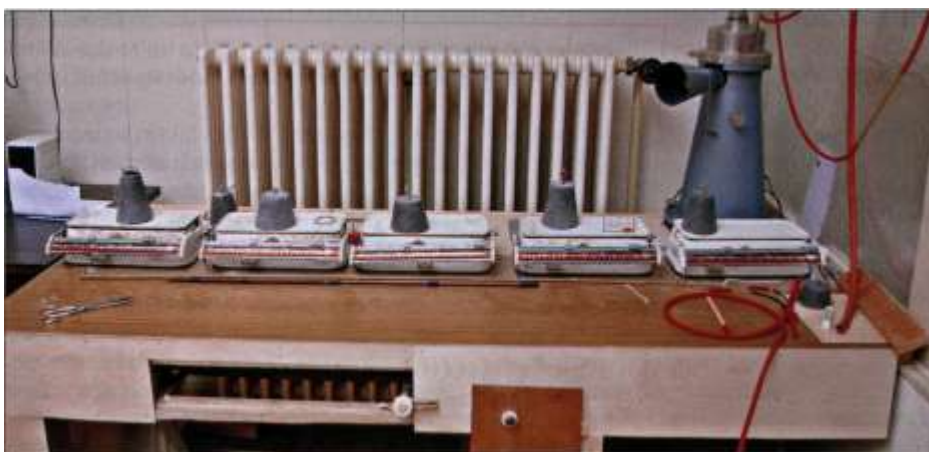
Die Messtechnik des Windkanals besteht aus einem Waagentisch, auf dem fünf Haushaltswaagen stehen. Auf diesen Waagen befinden sich 1500 g schwere Gewichte, an die mit Stahldrähten die Kräfte des am anderen Ende befestigten Strömungskörpers weitergeleitet werden.
