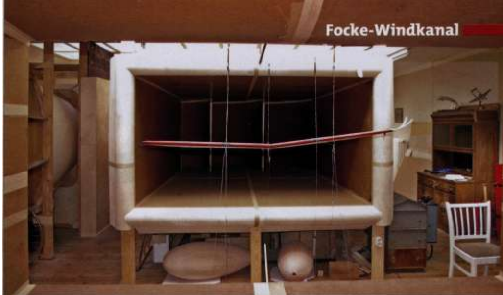
Ausblick von der Düse zur Messstrecke des Windkanals, wo als Versuchsobjekt die Tragfläche eines Modellflugzeugs aufgehängt ist.
