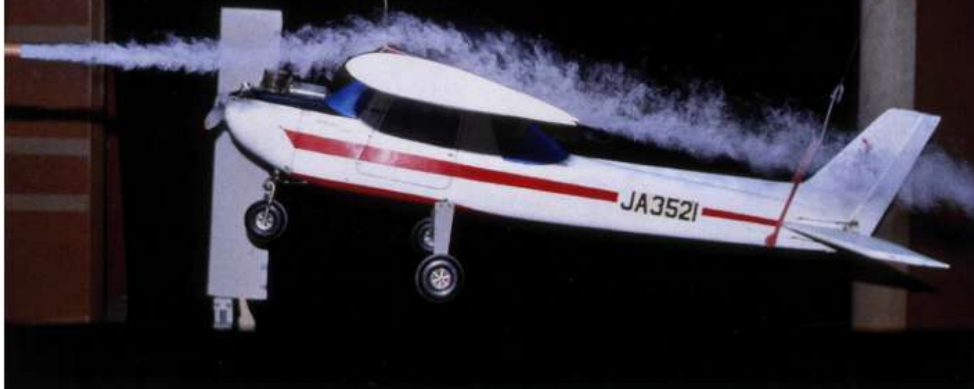
Ein handelsübliches Modellflugzeug mit einer Spannweite von 1,50 m im Focke-Windkanal. Die Umströmung der Tragfläche und der typische Randwirbel an der Tragflächenspitze werden mittels einer Rauchmaschine sichtbar gemacht. Focke Windkanal e. v.
