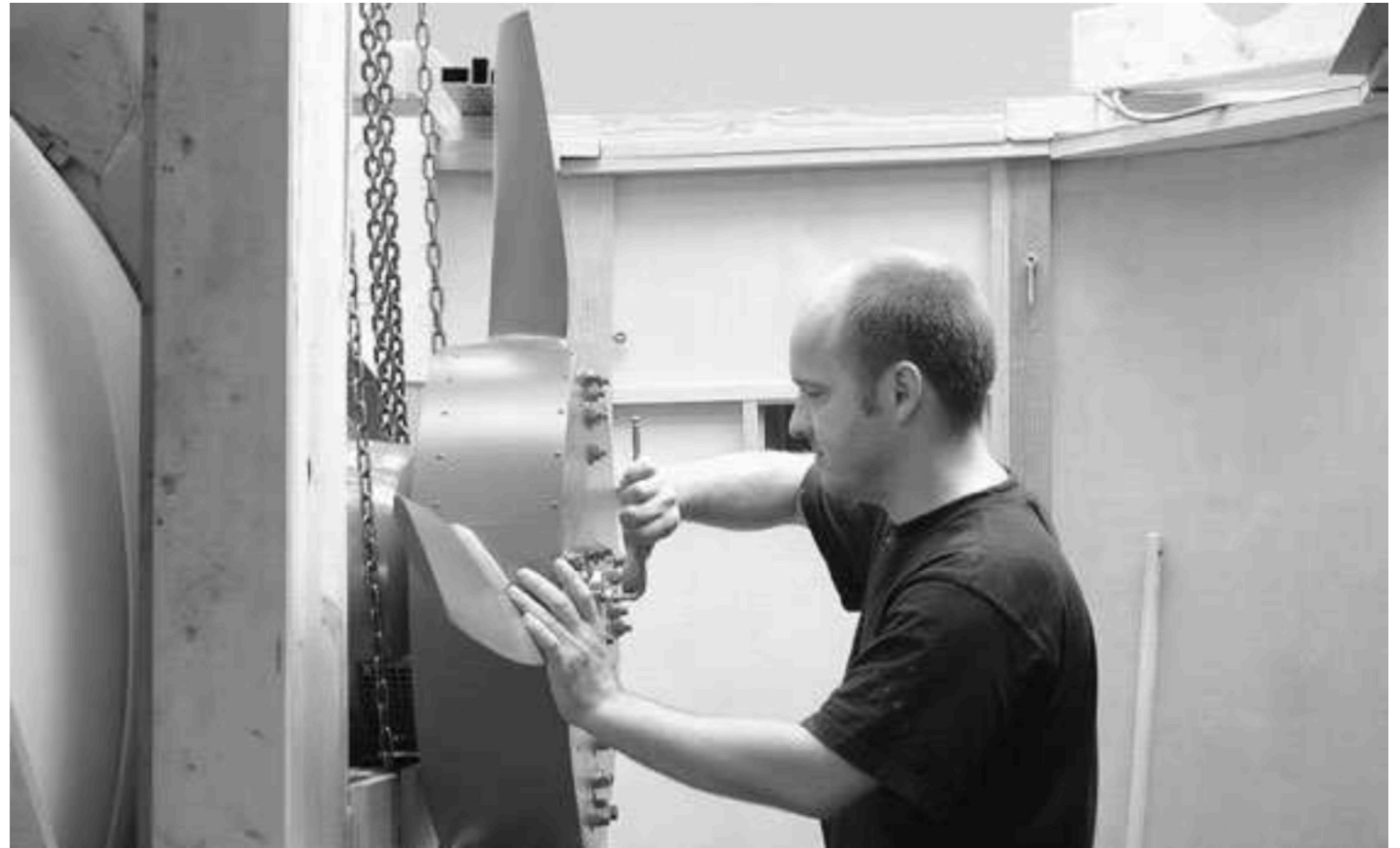
Kai Steffen montiert den Propeller, in dessen Bau und Entwicklung der Verein sieben Monate Arbeit investiert hat. Der Neubau gleicht dem Original von Heinrich Focke bis aufs Haar. FOTO: FR
