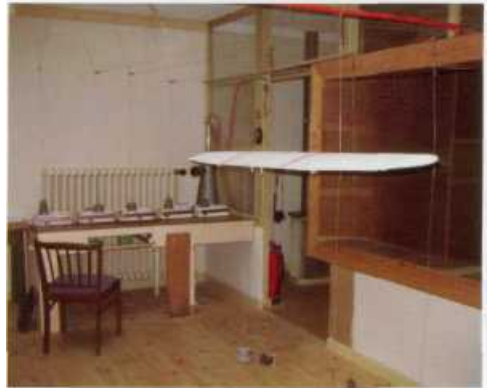
Messbereich des Windkanals mit dem Waagentisch vor und nach der Renovierung
