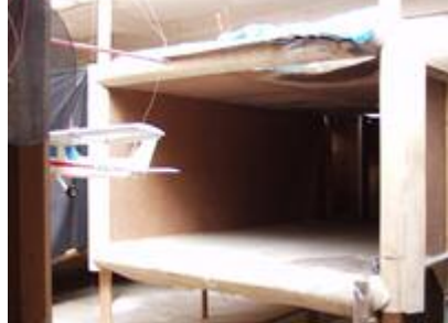
Komplett aus Holz: Der Focke-Windkanal - Tietgens, der sich ebenfalls an der Renovierung beteiligt. Foto: privat
