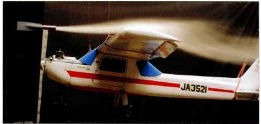
▲ Arbeitsprinzip: Das moderne Modell einer Cessna und eine Rauchmaschine veranschaulichen die Technik. (Foto: Kai Steffen, 2005)
