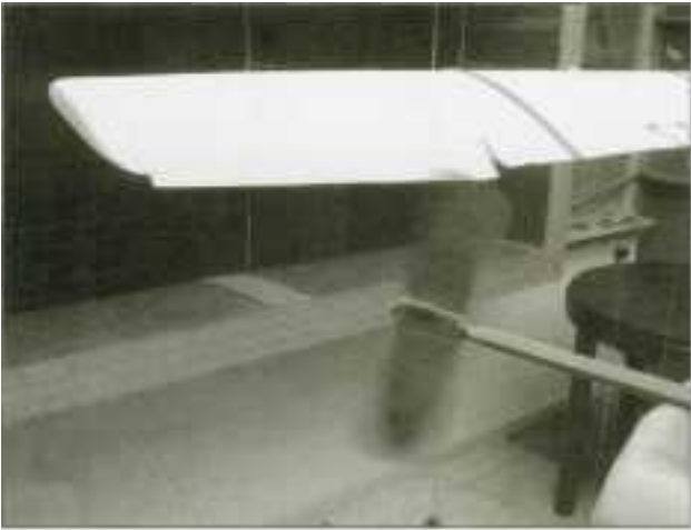
Verdeutlichung des Randwirbels mittels einer Drallsonde. Um die Wirkung zu erhöhen, ist das Querruder ausgeschlagen."
