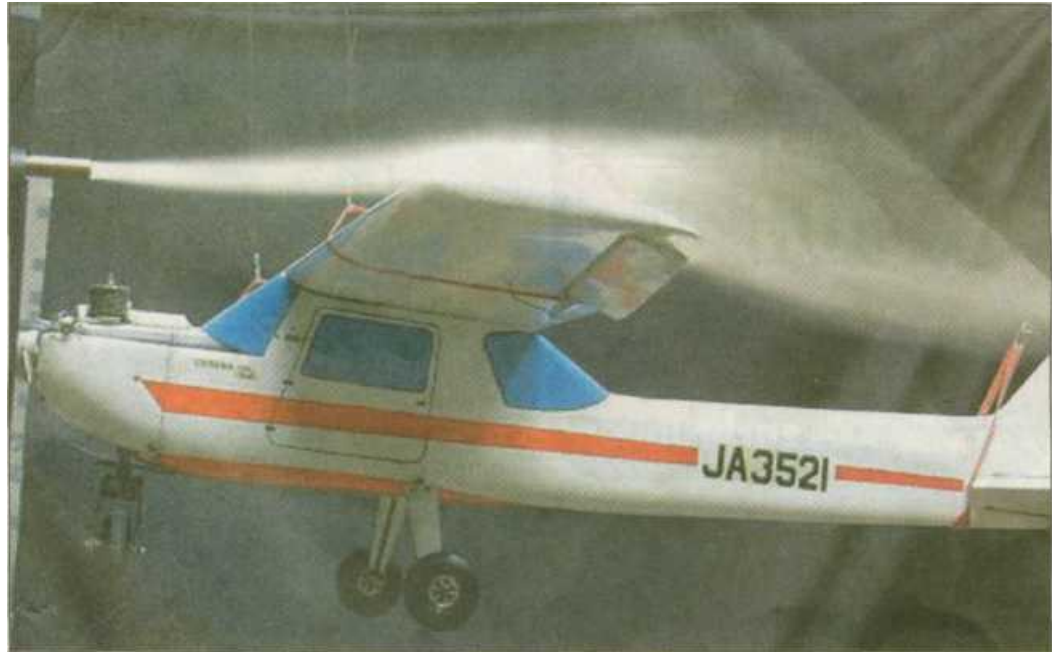
Das Modell einer Cessna-Sportmaschine mit einer Spannweite von 15 Meter wurde probeweise an die Waagen gehängt, um die Umströmung der Tragflächen sichtbar zu machen. Foto: av
